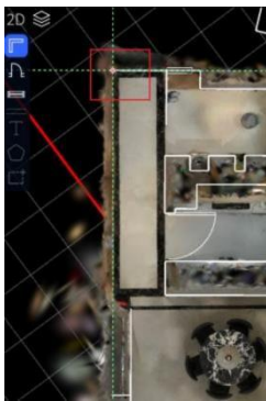
Startpunkt der Wand setzen
