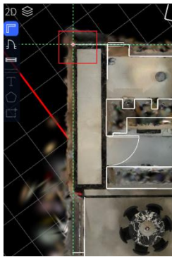
Colocar el punto inicial de la pared
