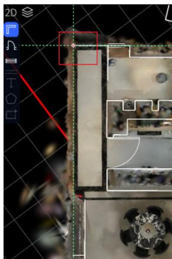
Posizionare il punto iniziale del muro
