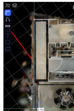
Posizionare il punto finale del muro
